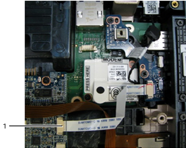
1 Connessione del cavo dello sniffer Wi-Fi alla scheda madre
