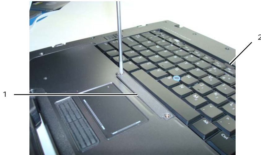
1 Supporto della tastiera 2 Linguetta di estrazione
