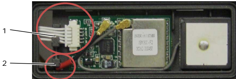
1 Guida del canale del cavo USB 2 Guida del cavo dell'antenna GPS passthru
